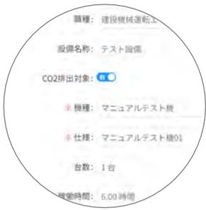
CO2排出量の算出を行うにあたり、持ち込み機械などの稼働時間、機種や仕様を登録します。
